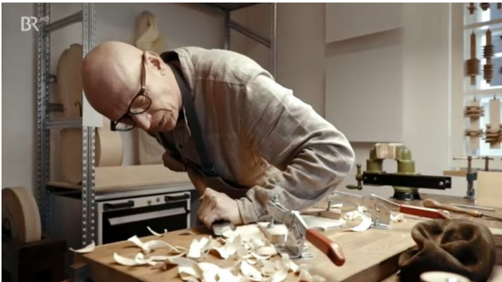
Geigenbaumeister Martin Schleske hobelt an der Decke für seine perfekte Violine © BR Klassik
